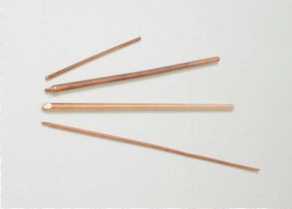
Şekil 1: Yuvarlak kesitli ve sinterli ısı borusu örnekleri
